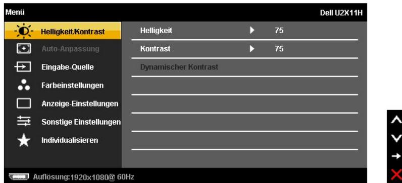
**HINWEIS:** Das automatische Justieren (AUTO ADJUST) steht nur dann zur Verfügung, wenn Sie den analogen (VGA)-Anschluss verwenden.
